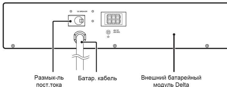
(Рисунок 8: Вид сзади внешнего батарейного модуля Delta)
