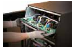
Легко заменяемые внутренние компоненты ускоряют и упрощают выполнение технического обслуживания*
